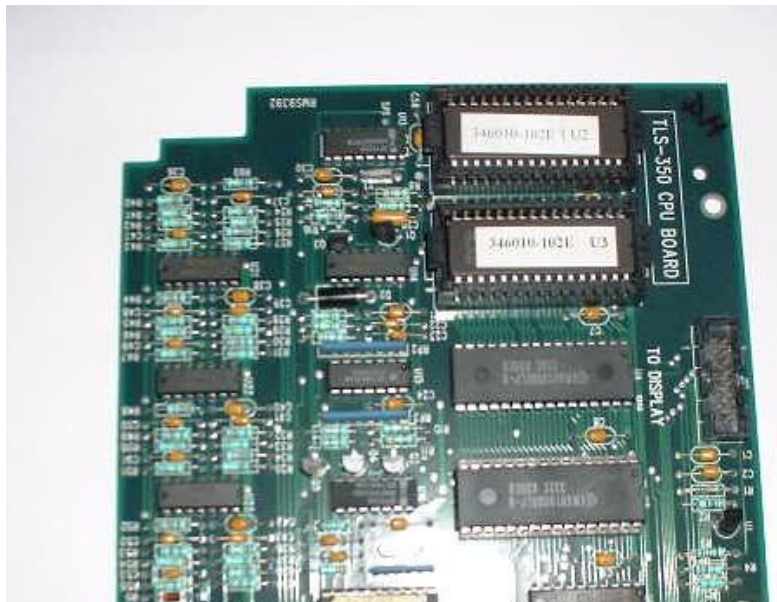
Abb. 6: CPU, DIL/DIP Bestückung, Best.-Nr. 330145-001
