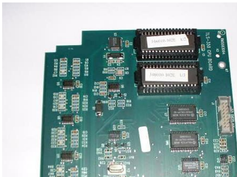
Abb. 7: CPU, SMD Bestückung, Best.-Nr. 330506-001
