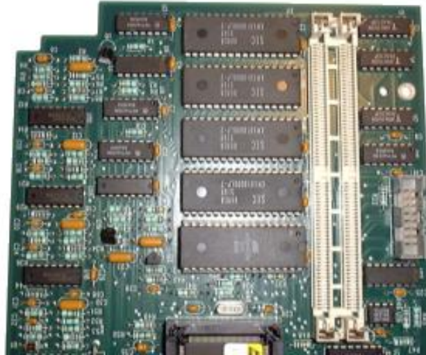
Abb. 1: ECPU, DIL/DIP Bestückung, Best.-Nr.: 330254-001
